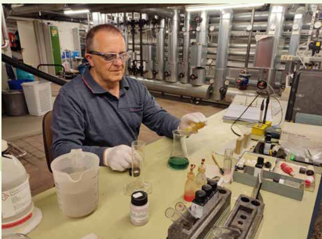
Jörg Langer testet Wasserproben für den Dampfkessel auf Wasserhärte
